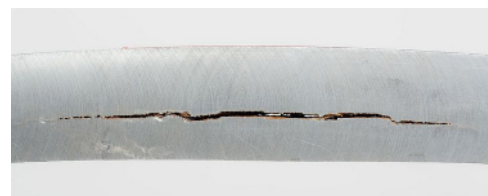
Abb. 3: Bruch durch Wasserstoffversprödung in Stahl. Q: commons.wikimedia.org Autor: Uwe Aranas
