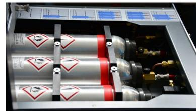
**Abb. 2:** Keine Gasflaschen, sondern Wasserstoffspeicher in Form metallartiger Hydride! Q: wikimedia.org Autor: Anjujo
