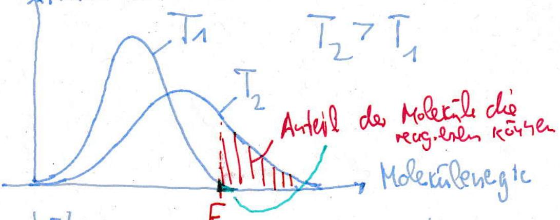
Bei der höheren Temperatur ( $T_2$ ) hat ein Ausgangsstoff die notwendige  $E_A$  überschritten. Die Verteilungskurven stellen sich stets neu ein, d.h. nach Aggregation werden ständig Moleküle nachgeliefert, mit der notwendigen  $E_A$ .
