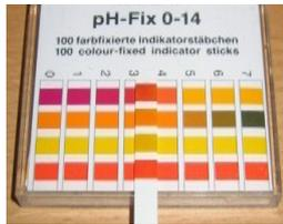
Auch bei **pH-Indikatorstäbchen** sind auf jedem der Testfelder Einzelindikatoren oder Indikatorgemische untergebracht. Durch Vergleich kann man relativ genau auf den pH-Wert schließen der Probenflüssigkeit schließen.
