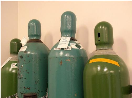
Gasflaschen, bereit zum Transport mit 'Schutzkappe. Mit einer Kette sind sie vor Umfallen gesichert.
