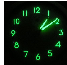
Abb. 4: Leuchtendes Ziffernblatt – ein Beispiel für Radiolumineszenz . (Quelle: commons.wikimedia.org. Autor: Arma95)
