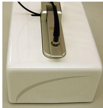
**Abb. 3.2:** Spektralfotometer mit geschlossenem Deckel
