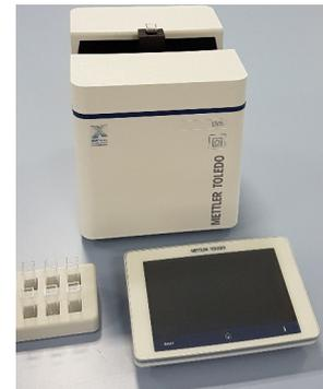
Abb. 4.2: Abbildung eines Diodenarray-Fotometers. Quelle: wikipedia.de
